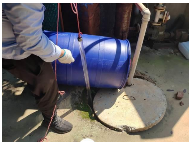
污水处理站附近地下水监测井（☆1#）
