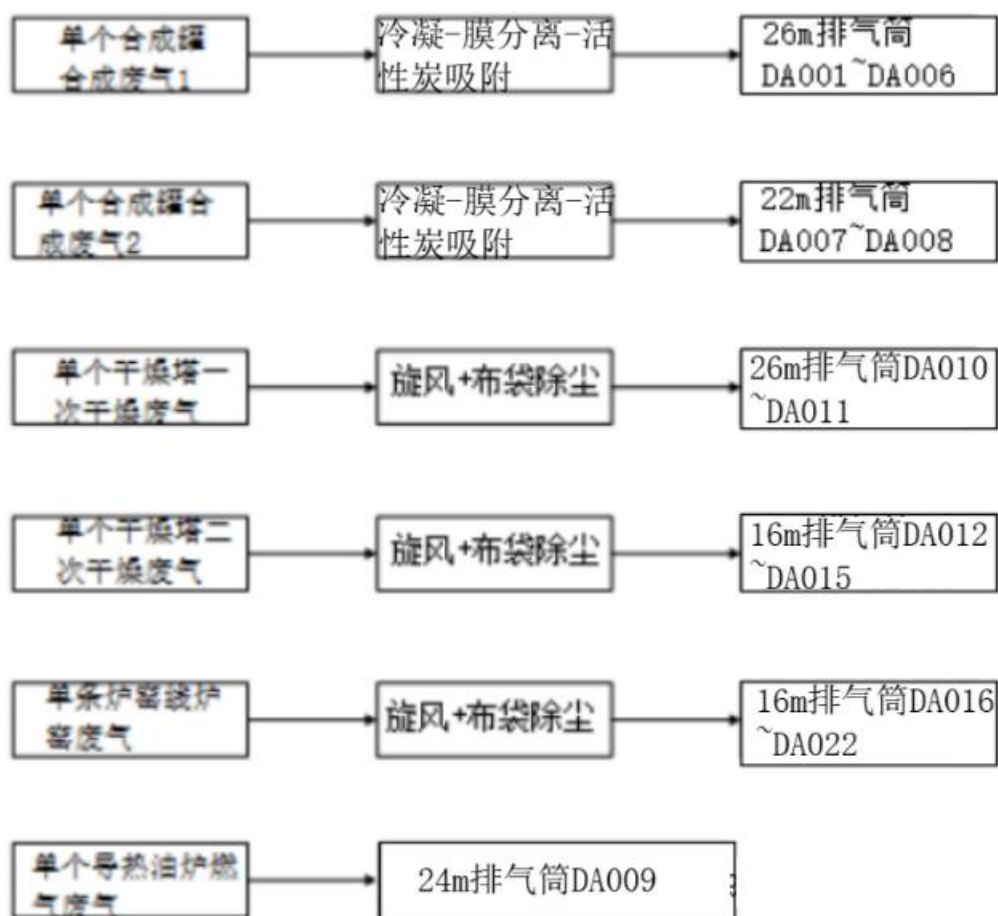
图9.2-1 项目废气收集系统走向图
