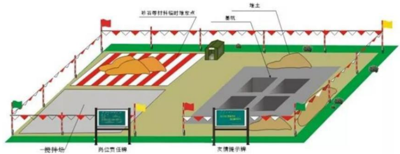
图 2-4 典型塔基施工平面布置示意图
